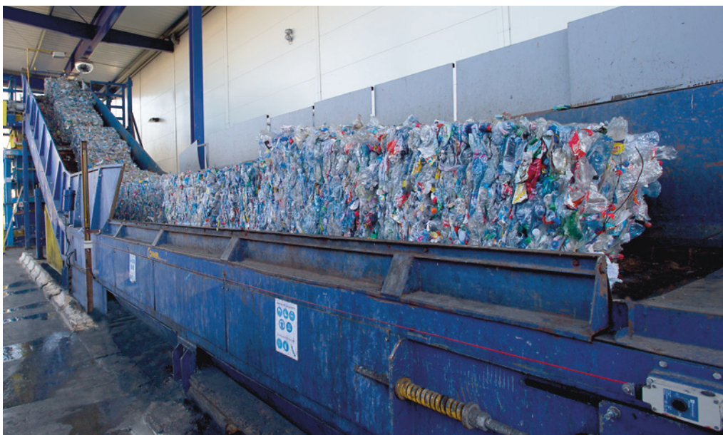
Déconditionneur de balles contenant des bouteilles plastiques collectées, Usine France Plastique Recyclage, Limay. Crédits photo : SUEZ
